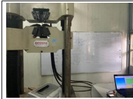
Fig. 6 Tensile test device
