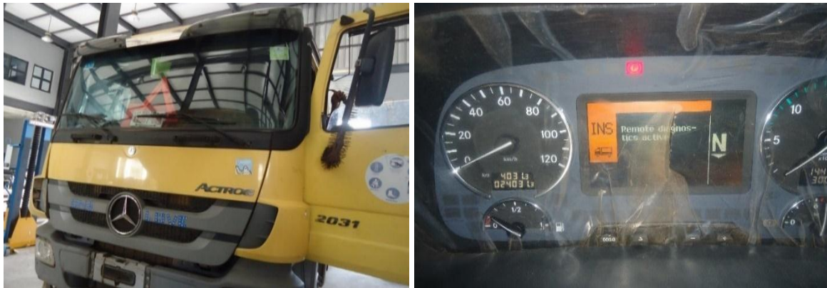
Fig. 3 (b): Test truck; Actros Truck model MP 2, 2031 and Xentry Connect module, (Ndubuisi et el 2022).
